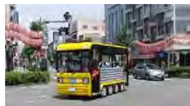
←「地域に根ざした脱温暖化・環境共生社会」[戦略創造研究推進事業(社会技術研究開発)]の成果（8輪すべてが動輪のEVコミュニティービーグル）
