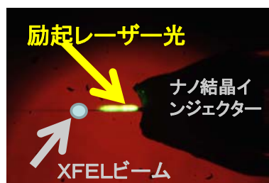
可視光レーザーによるマイクロ秒ポンプ&プローブ実験
