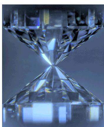
マントル物質を二つのダイヤの間に挟み、超高压下でレーザー加熱を行って、実験室でマグマを作る。
