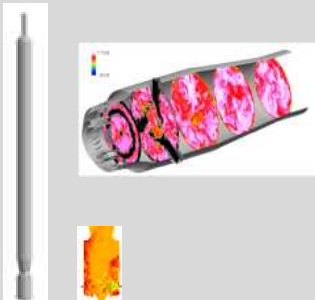
石炭ガス化炉と燃焼器の実証試験機における燃焼解析の様子
