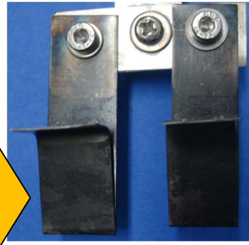
200℃ナトリウムに浸漬後常 温Arガス中保持4回繰り返し (2分×3回、3分×1回)
