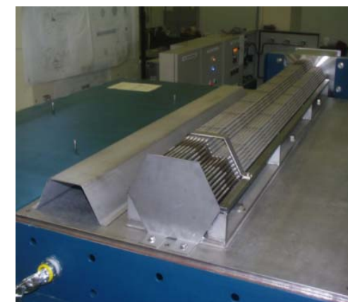
集合体組立時の除熱試験装置
