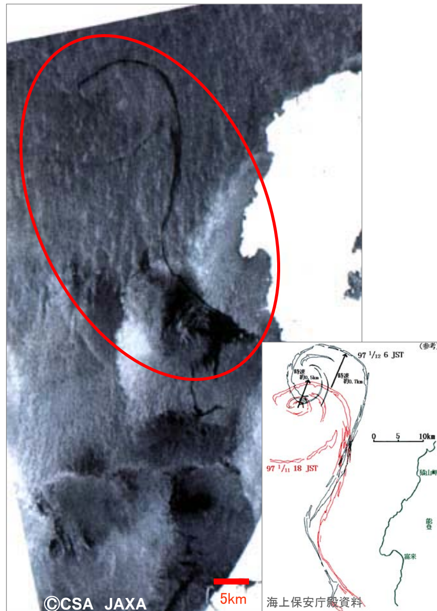
全天候センサ(RADARSAT/SAR)画像による日本海における漂流オイルの観測(1997年1月11日)
