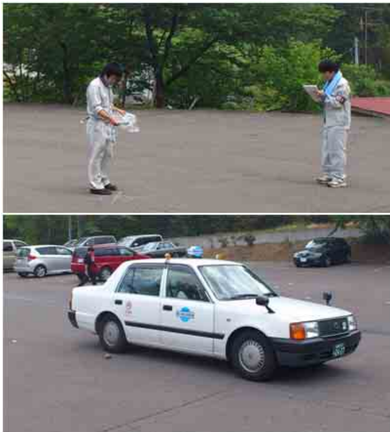
写真2 車体によるシールド効果の確認 (上:車外での測定、下:車内での測定)
