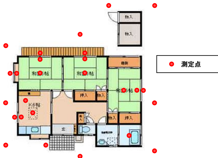
図1 アパート・マンションタイプの測定点
