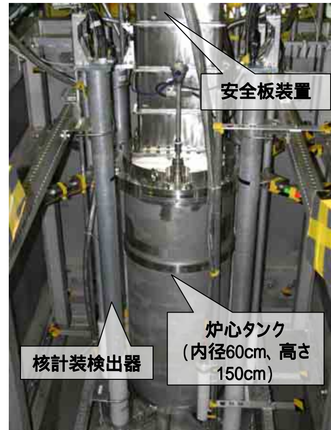
STACY炉心タンク (非均質炉心)
