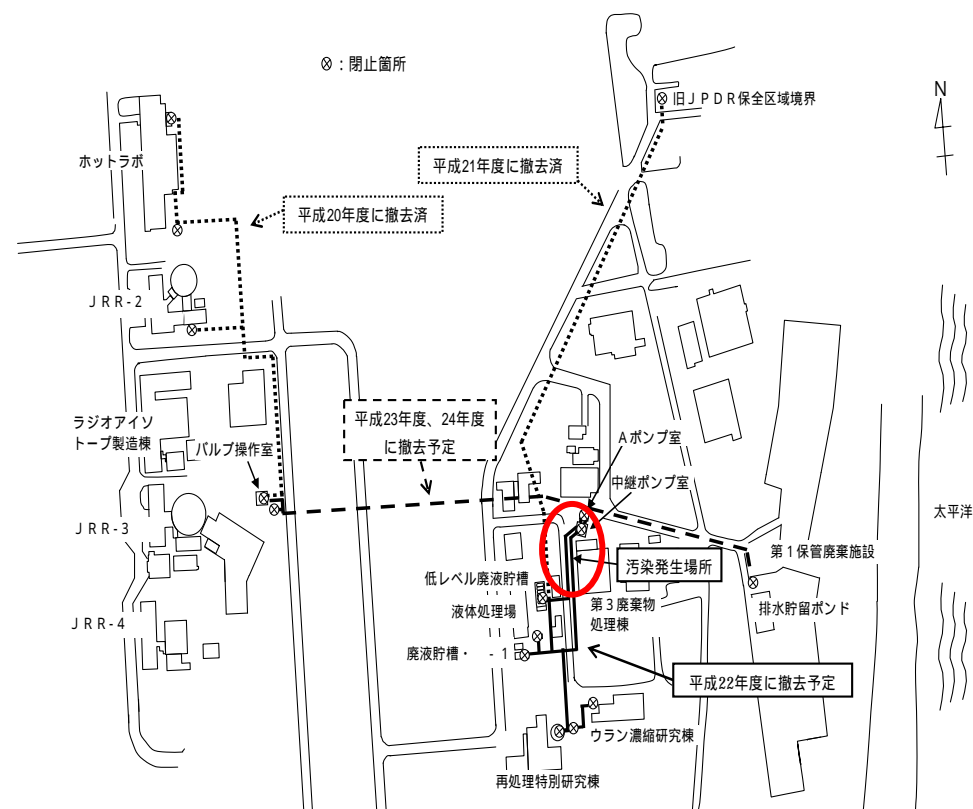
図2 廃液輸送管の全体図
