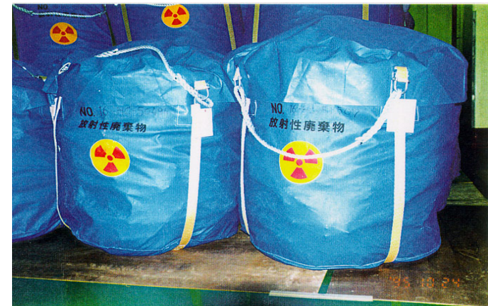
コンクリート廃棄物を収納したフレキシブルコンテナ
