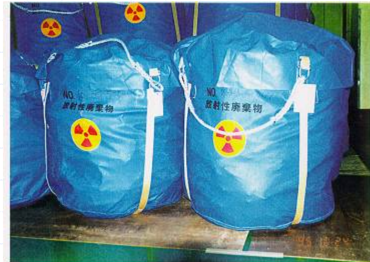
(写真) 非固型化コンクリート等廃棄物を収納したフレキシブルコンテナ (写真提供: 日本原子力研究開発機構)
