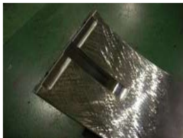
「キサゲ加工」を施したエンジンの部品
