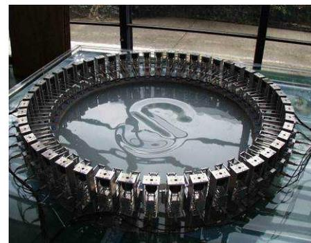
実海域再現水槽の開発。造波性能の評価のために、一例として水面に波で文字を描いた。
