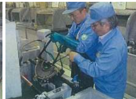
航空機用エンジン部品のニッケルカドミウムめっき作業の指導風景
