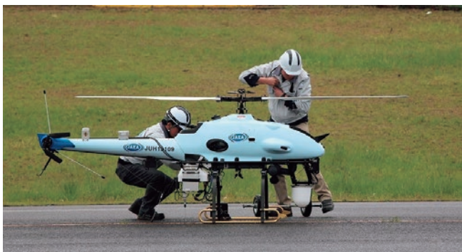
放射線計測機器搭載無人ヘリ
