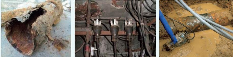
配管の腐食
