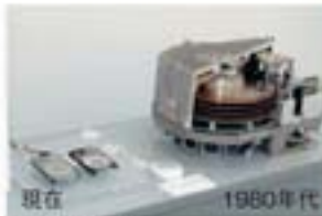
現在 1980年代 新旧HDDの比較 (大幅に小型化し、しかも容量は1000倍になった。)
