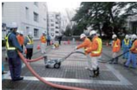
超高圧水洗浄技術の実証試験 (福島大学キャンパスにて)
