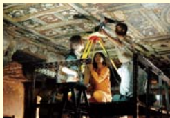
携帯型蛍光X線分析計を用いた 顔料の非破壊分析 (インド アジャンター石窟壁画)
