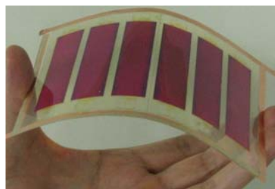
新原理の太陽電池（色素増感系太陽電池）の試作品（物質・材料研究機構）
