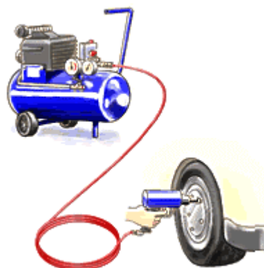
図 2 エアーコンプレッサーを使ってボルトを締める (コメリドットコムホームページ資料をもとに作成)
