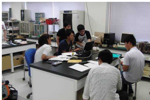
富山高専における放射線計測実習 Ge 半導体検出器による環境放射線計測によりバックグラウンド放射線について理解させた。
