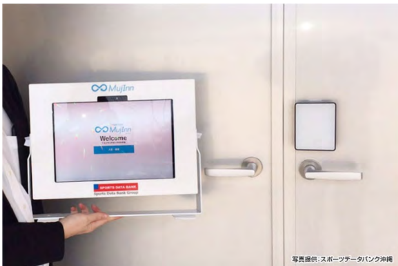
タブレットのスマートチェックインと既存の鍵に設置されたスマートロック
